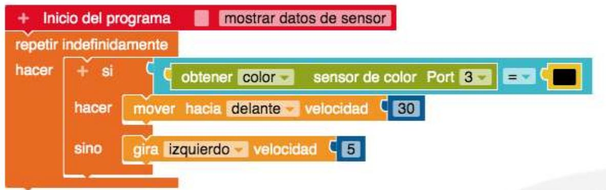
**Pista:** para establecer la condición de obtener el color del sensor de color y saber si es igual a negro, hay que utilizar un bloque de Lógica, un bloque de Sensores y un bloque de Colores.
